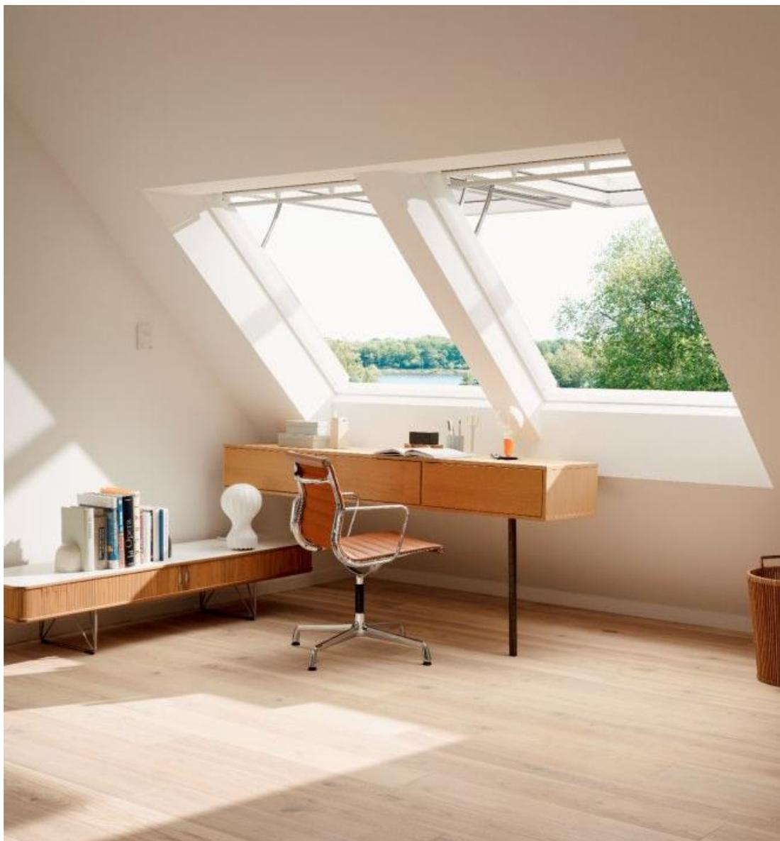
Le finestre per tetti [Velux Vetrata Performance](#) sono disponibili con sei tipologie di vetrata, stratificate e bassoemissive, con trasmittanza fino a  $0,5 \text{ W/m}^2\text{K}$  e fattore  $g_{gl+sh}$  (fattore solare della combinazione vetro/ dispositivo di controllo solare) fino a  $0,02$ .
